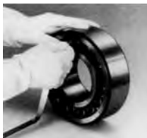
Рис. 1. Проверка зазора подшипника на верстаке.
